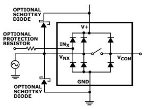
**FIGURE 9. OVERVOLTAGE PROTECTION**
