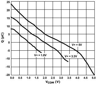
FIGURE 19. CHARGE INJECTION vs SWITCH VOLTAGE
