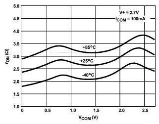
FIGURE 12. ON-RESISTANCE vs SWITCH VOLTAGE
