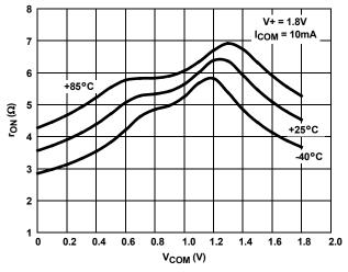
FIGURE 13. ON-RESISTANCE vs SWITCH VOLTAGE
