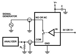
FIGURE 4. OFF-ISOLATION TEST CIRCUIT
