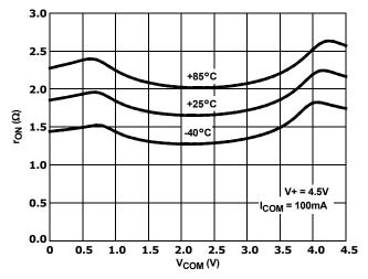
FIGURE 11. ON-RESISTANCE vs SWITCH VOLTAGE
