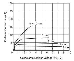
COLLECTOR CURRENT vs. COLLECTOR SATURATION VOLTAGE
